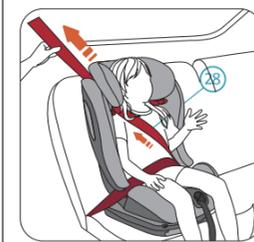
5. Ziehen Sie zuerst am Schultergurtteil, der den Körper des Kindes kreuzt, um den Durchhang vom Schenkelabschnitt zu entfernen. Ziehen Sie dann den Schultergurtteil (28) über den Kindersitz, um den verbleibenden Durchhang zu entfernen.
