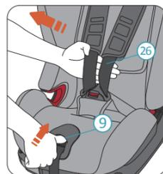
1. Halten Sie den Zentralgurtlängenversteller (9) gedrückt und ziehen Sie den Schultergurt (26) so weit wie möglich zu sich. Stellen Sie sicher, dass Sie den Schultergurt wie gezeigt von unterhalb der Schulterpolster ziehen.
