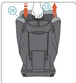
3. Bedienen und halten Sie den Kopfstützenverstellgriff (13) an der Rückseite der Kopfstütze, wodurch die Kopfstütze entsperrt wird.
