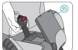
9. Öffnen Sie die Gutschlossfachabdeckung (35) unter dem Sitzbezug. Drücken Sie das Schloss durch den Schlitz in der Abdeckung und legen Sie es in das Schlossfach. Schließen Sie dann die Fachabdeckung.
