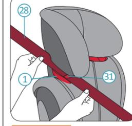
4. Führen Sie den Schultergurt (28) durch die rote Schultergurtführung (1) der Kopfstütze, bis er vollständig in der Schultergurtführung liegt und die Sperre (31) geschlossen ist und der Schultergurtabschnitt nicht verdreht ist.
