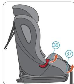
1. Schieben Sie die Kopfstütze auf die höchste Position! Lösen Sie die Bezugbefestigungshaken (36) an den Bezugbefestigungshaken (36) an den Beckengurtführungen und die elastischen Bänder (37) an der Vorderseite des Sitzes an beiden Seiten. Entfernen Sie dann die Sitzbezug.
