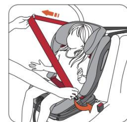
1. Positionieren Sie den fahrzeugeigenen 3-Punkt-Gurt vor dem Kind und lassen Sie den Gurt im Schloss des fahrzeugeigenen 3-Punktgurtes mit einem Klick einrasten. Stellen Sie sicher, dass der 3-Punkt-Gurt nicht verdreht ist.
